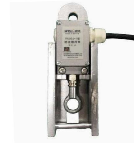
用于其重機鋼絲繩防過卷的一種機械式自動保護開關,它與一適合重量的重錘配套使用,利用吊鉤的上下運動托起或放下重錘時斷開或接通開關,實現自動切斷卷揚機動力電源,達到限制鋼絲繩過卷的目的.
