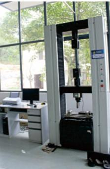
电子式万能试验机
